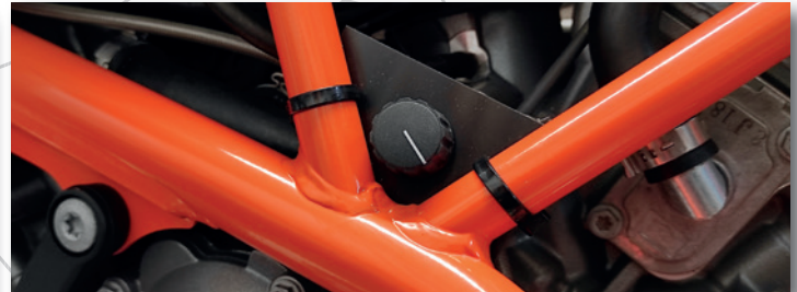
Bild 11 Drehschalter mit Halteplatte im Rahmen
