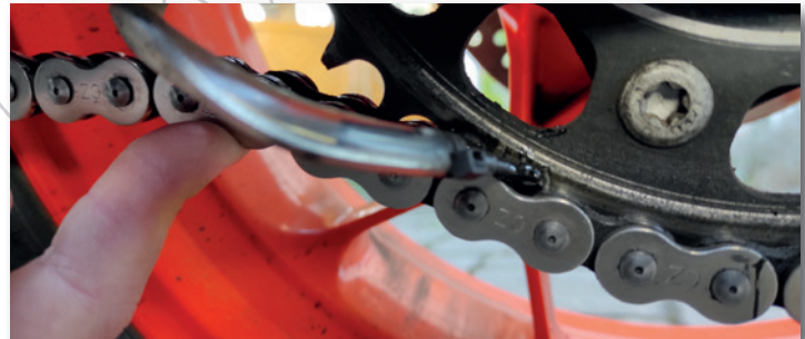
Bild 35 Falsche Düsenposition: die Kette berührt die Düse.
