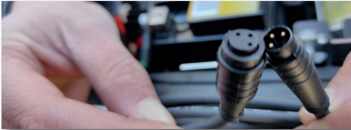
Bild 13 Stecker des Drehschalterkabels
