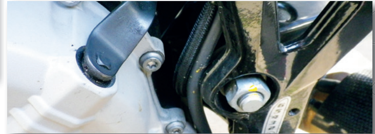
Bild 44 Ölleitung an der Husqvarna Nuda 900 am Schwingendrehpunkt im Sichtbereich, daher mit Geflechschlauch überzogen
