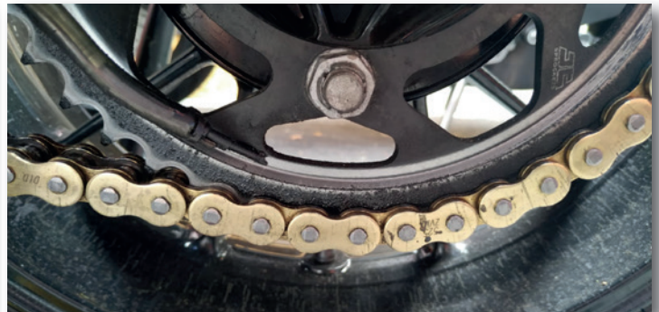
Bild 39 Falsche Düsenposition: die Düse läuft im Absatz des Kettenrades (wenn vorhanden); Sie sollte auf dem Absatz laufen.
