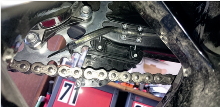
Bild 36 Richtige Düsenposition: die Düse ist nicht zu weit vom Auflaufpunkt der Kette auf das Kettenrad entfernt.
