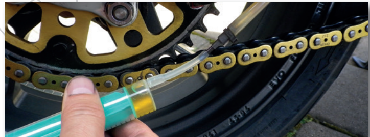
Bild 46 Einwegspritze mit Silikonschlauch auf Düse gesteckt und Ölleitung entlüftet
