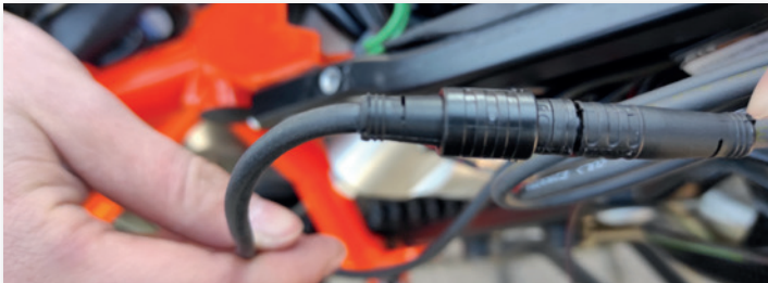
Bild 14 Stecker aufgesteckt (nicht verriegelt)
