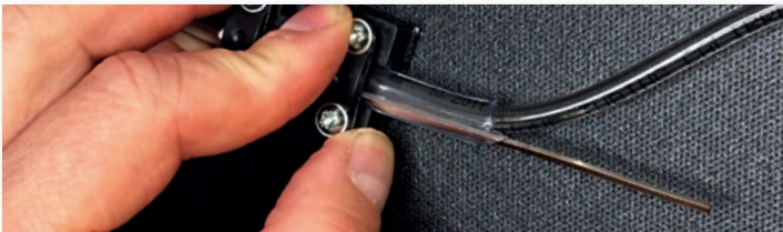
Bild 19 Oberschlauch ringsum abschneiden
