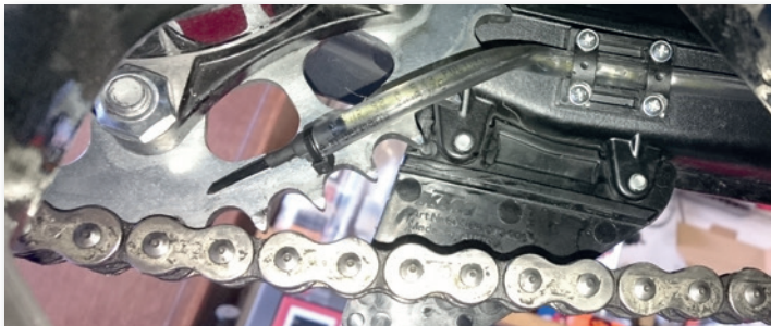
Bild 31 Ölleitung im Bogen um das Kettenrad herumgeführt. Düse an der Rückseite des Rades angelegt.
