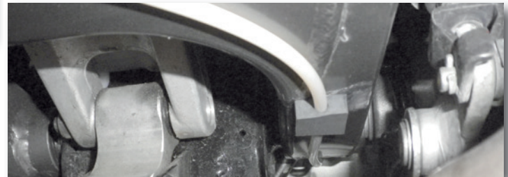
Bild 28 Führung der Ölleitung unter der Schwinge um den Schwingendrehpunkt herum
