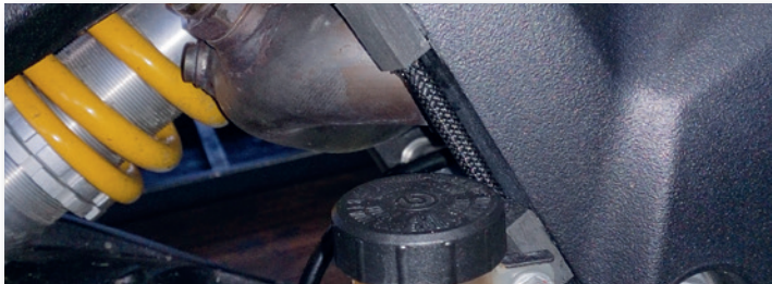
Bild 43 Ölleitung an einer Ducati Monster 1100 EVO, zwischen den Halteklötzen mit Geflechschlauch überzogen
