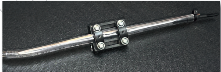
Bild 17 Ölleitung im Halteklotz
