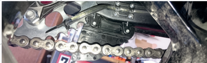
Bild 24 Montage Halteklotz Zweiarmschwinge Düse Innenseite
