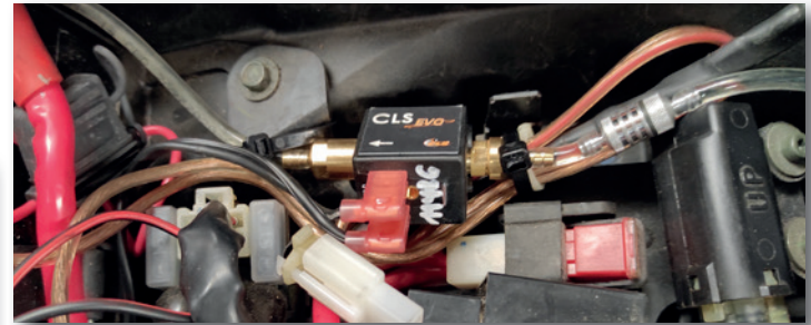
Bild 9 Pumpe mit Kabelbinder im Fahrzeug fixiert.
