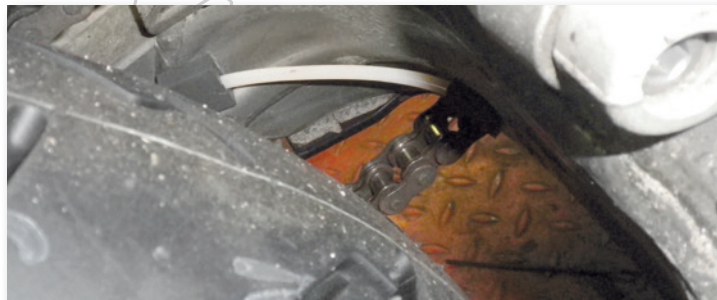
Bild 40 Ölleitung an der Innenseite der Schwinge verlegt
