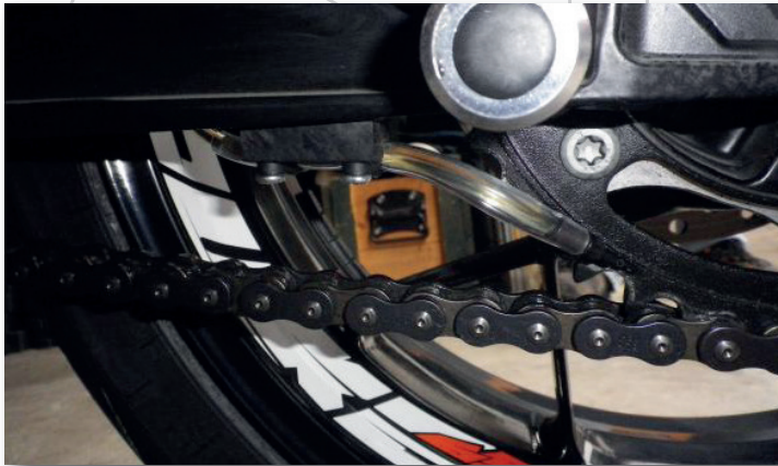
Bild 29 Halter unter der Schwinge. Düse von außen ans Kettenrad
