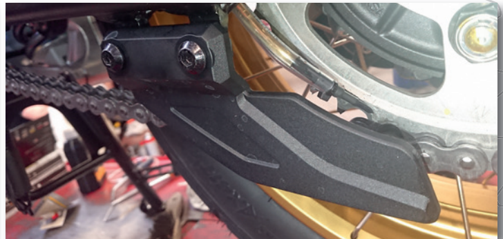
Bild 38 Richtige Düsenposition: die Düse läuft auf dem Absatz des Kettenrades.
